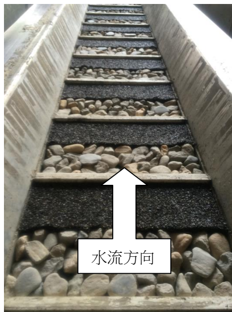
圖 1. 完成前置的試驗渠槽之範例
