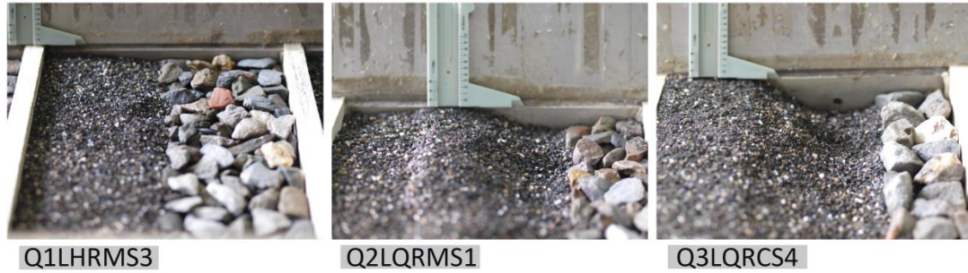
圖 4.拋石保護段下游的局部淘刷(坡降 S1 =0.030；坡降 S3 =0.066；坡降 S4 =0.085；流量 Q1= 0.00058cms；流量 Q2= 0.00078cms；流量 Q3= 0.00093cms；拋石長度 LQ=0.05m；拋石長度 LH=0.10m；拋石粒徑 RM=16.75mm；拋石粒徑 RC=21.77mm)
