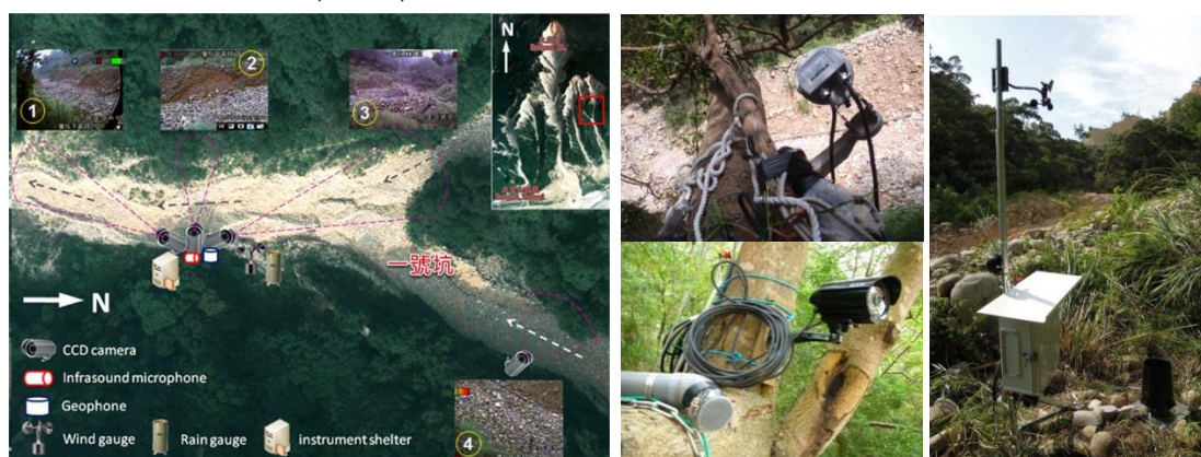
圖 2 火炎山一號坑監測配置示意圖
