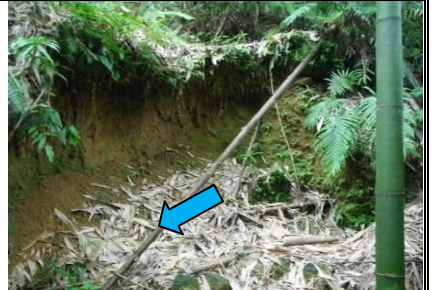
12. 右側支流上游側, 小型圓弧型崩塌(308683, 2768365)
