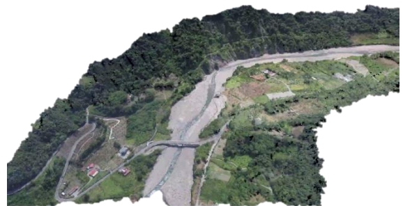
圖 17 建構立體視圖_近景攝影量測
