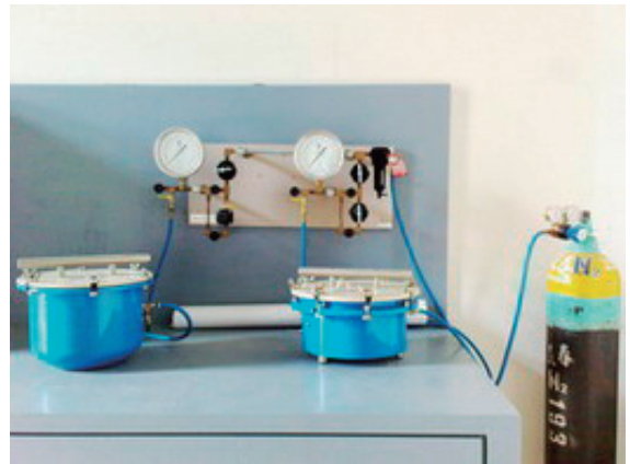
圖 2 壓力鍋實驗儀器配置圖 Fig.2 Layout of the pressure plate test
