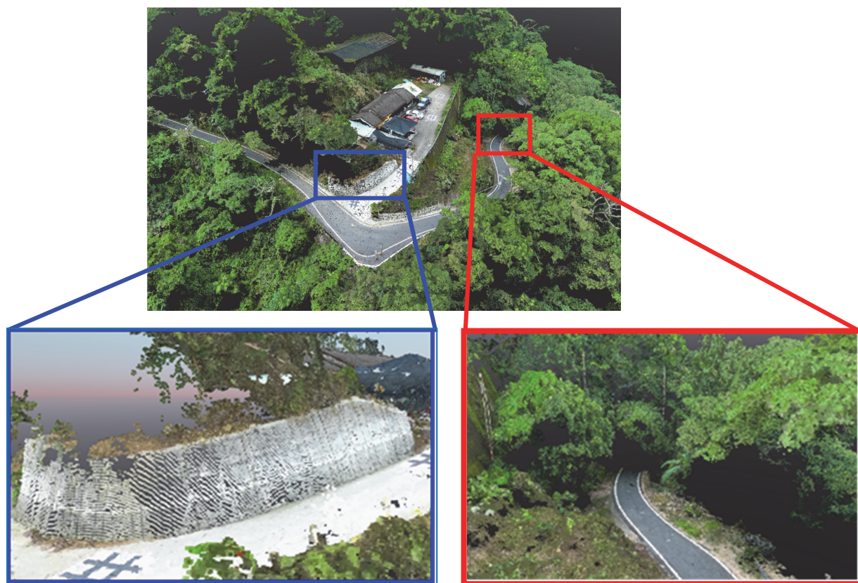
圖 8 UAV 點雲模型，其中紅框和藍框分別顯示點雲缺失和粗糙的構造物外觀
