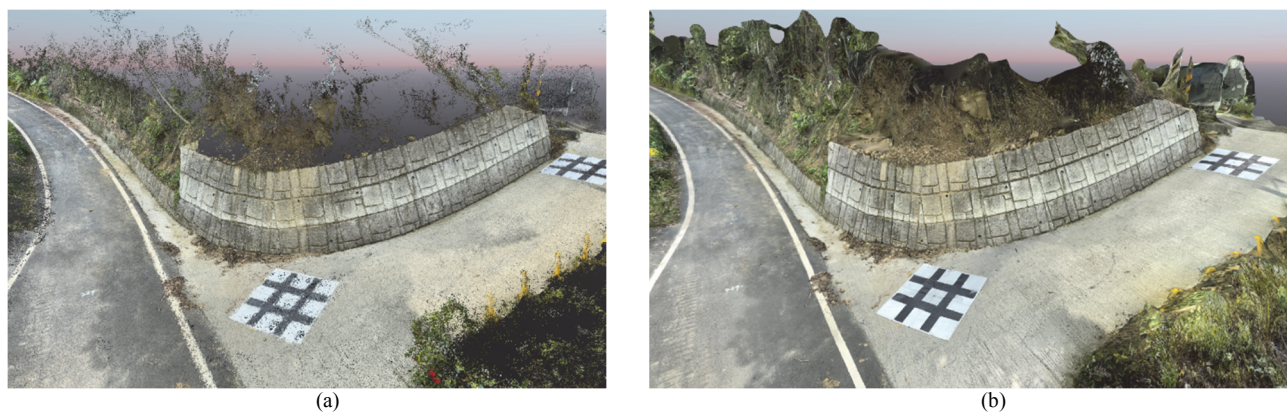
圖 9 viDoc 模型。(a) 點雲模型；(b) 網格模型
