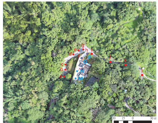
圖 6 控制點與檢核點分布圖 (紅點為 UAV 與 viDoc 模型融合連接點位置，藍點為絕對精度分析選點位置)
