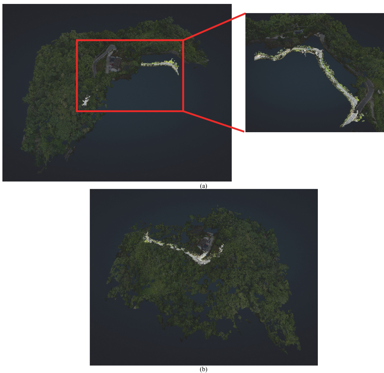
圖 11 UAV 與 viDoc 三維模型融合成果 (a) 座標參數未轉換；(b) 七參數座標轉換
